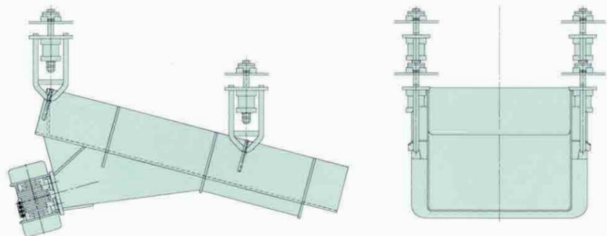
二次・三次破碎機への定量供給、あるいはストックビンからの定量引出し機として設置できます。本機は標準として吊下げ方式です。
