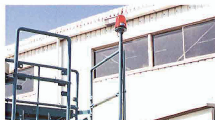
過負荷停止外部表示灯
