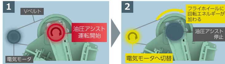
大きなトルクが必要な起動時は、油圧アシスト装置で運転し、フライホイールへ回転エネルギーを蓄積後、効率が良い電気モータへ切り替えます。起動トルクに縛られず小さな電気モータを選定することができるので、燃費低減につながります。
