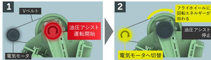
大きなトルクが必要な起動時は、油圧アシスト装置で運転し、フライホイールへ回転エネルギーを蓄積後、効率が良い電気モータへ切り替えます。
