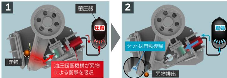
万が一、異物を噛み込んだ時は油圧緩衝機構が衝撃を吸収し、クラッシャを保護します。検知された異物は排出され、セットは自動復帰します。
